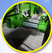
Выдвижная ось на 700 мм 13 т (на неподвижной оси)
