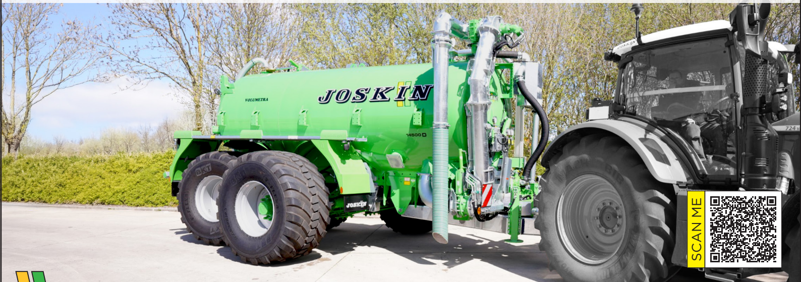
Выдвижная ось на 700 мм 13 т (на неподвижной оси)
